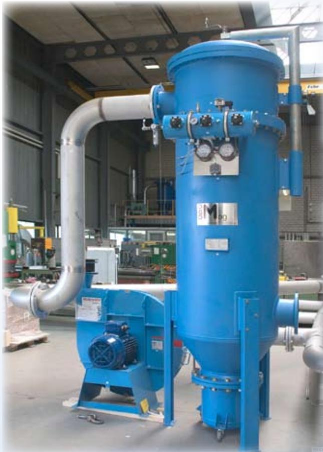
Die AeroEx Trockenentstaubungsgeräte eignen sich besonders für die Filtration von explosiven Stäuben und hybriden Gemischen in allen Industriebereichen. AeroEx Geräte sind druckstossfest bis 13 bar nach VDI 2263 ausgelegt.
